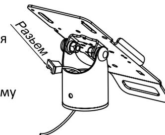
5. Установка устройств с захватом подписи на платформу
