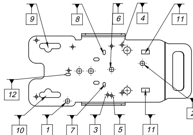
г) CASTLES. Установите устройство на позы 11 и прикрепите его к площадке винтом M2x8 через отверстие 12
