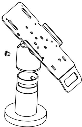
1. Отверните стопорный винт и снимите верхнюю часть кронштейна
