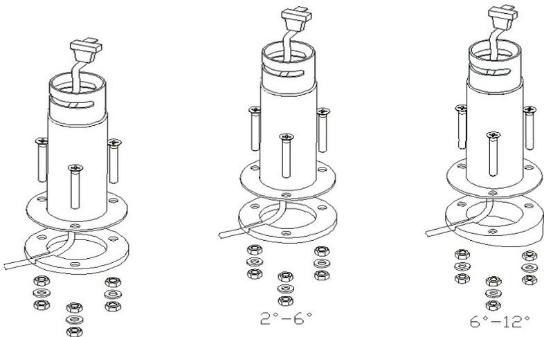
3. Установка кронштейна на поверхности с уклоном:
